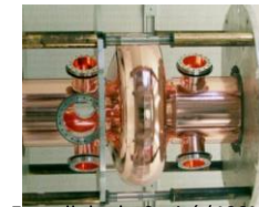
Ex: cellule de Cavité (400MHz) cuivre (avant dépôt niobium) pour ions proton
