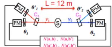
$C_1, C_2$  : commutateurs optiques envoyant les photons vers deux polariseurs orientés suivant  $\theta_1, \theta_1'$  (ou  $\theta_2, \theta_2'$ )
