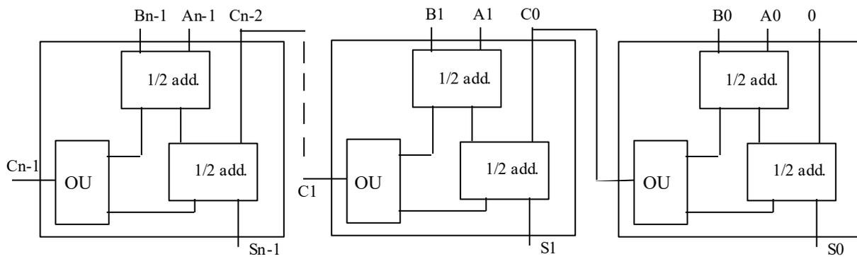
**N.B.** Le temps de calcul est proportionnel au nombre d'additionneurs élémentaires, à cause de la retenue propagée.
